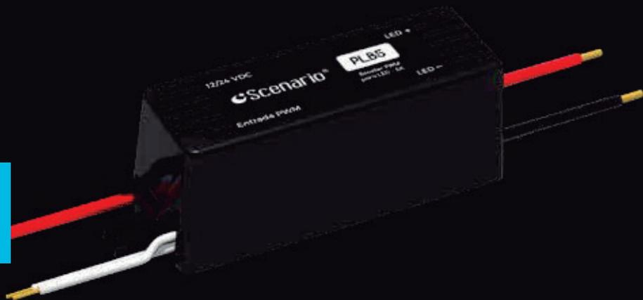
Booster de 1 canal para módulos PWM (PML3 e PML4 e PWM-wifi). Utilizado para o acionamento de segmentos adicionais de até 5A (12v ou 24v) para cada booster, controlados por um canal pwm. Mais de um booster pode ser ligado a um mesmo canal pwm, conforme a necessidade.
