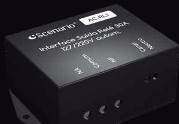
Interface com relé de 30A utilizada para acionar cargas com consumo de corrente maior que a suportada pelo canal do módulo que faz o acionamento. Controla cargas não dimerizáveis, como motores ou reatores eletromagnéticos de lâmpadas fluorescentes. Trabalha vinculado a um canal do EB-SDM8-STD, EB-SDM8-MAX, EB-CW6-WIFI, módulo controlador de cenas CompactWall Six ou CompactClassic. Possui alimentação bivolt automática.
