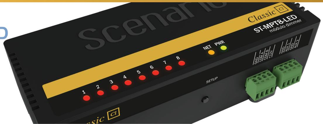
Módulo para controle e dimerização de até 8 canais para lâmpadas tipo LED dimerizáveis, incandescentes, 12 volts com transformador dimerizável. Com capacidade de até 1.600W (200w máximo por canal), permite um bom funcionamento com lâmpadas de tecnologia LED, mesmo com baixa potência no canal (mín de 3W).
