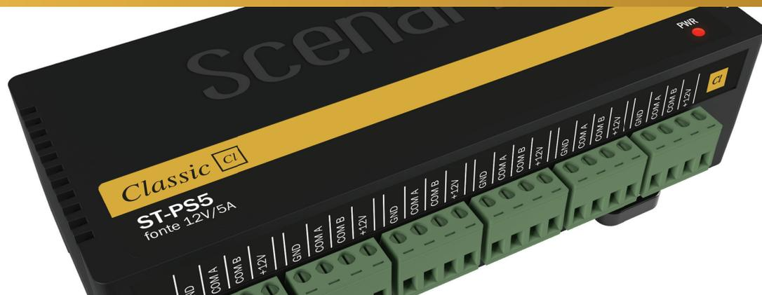
Fonte de alimentação para Sistema Classic, acoplada a um hub de seis portas para a interconexão da rede Classic-Net. Possibilita a organização da rede em ramais, facilitando a instalação e manutenção do sistema. Podem ser utilizadas em dupla para implementação de redundância. Fixação em trilho din.
