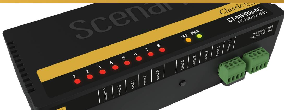
Módulo de relés com oito canais para acionamento de cargas liga/desliga ou de motores de acionamento de cortinas do tipo AC com reversão. Capacidade para até oito cargas do tipo liga/desliga, como lâmpadas fluorescentes, telão, equipamentos de home-theater, motores, etc (chamadas “cargas não-reguláveis”); ou quatro motores de cortina e toldos AC. Possui duas entradas auxiliares. Fixação no quadro de automação por trilho DIN.
