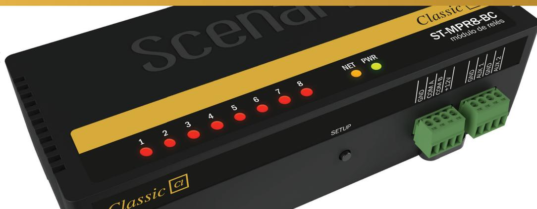
Módulo com oito canais de acionamento por relés independentes, para controle de carga de baixa corrente e voltagem por contato seco. Aplicável nas situações onde se faz necessário o acionamento do tipo liga/desliga, tais como: telas de projeção, cortinas motorizadas, integração com sistemas de alarme etc. Fixação no quadro de automação por trilho DIN.
