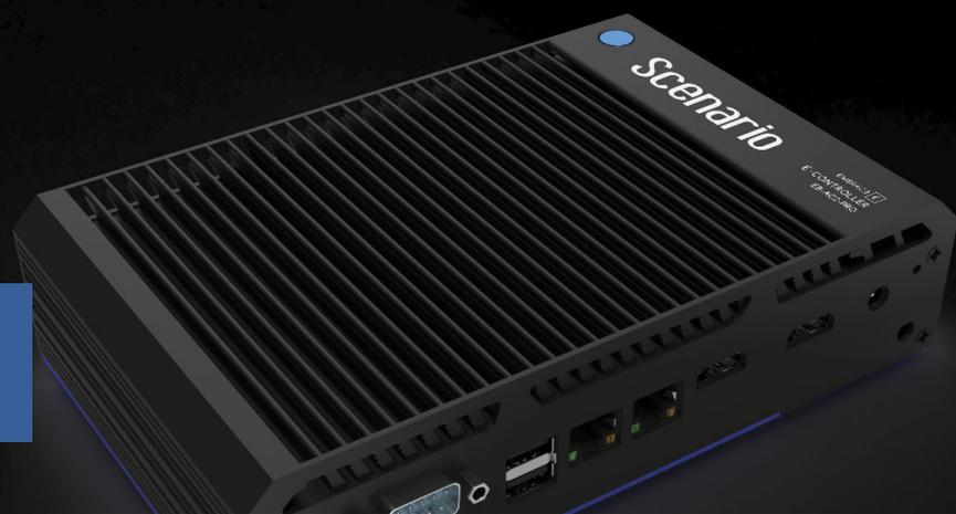
Processador de automação para a linha Embrace. Responsável por toda a programação lógica e da comunicação do sistema com o *E-App* e a *Embrace Cloud*. Duas portas Ethernet, uma para conexão com a rede local da instalação e outra exclusiva para a rede de EB-NTL1's, isolando a comunicação básica de controle Embrace de eventuais problemas da estrutura de rede de uso geral. Também dispõe de 4 portas de comunicação serial RS-232 para o controle de equipamentos compatíveis.
