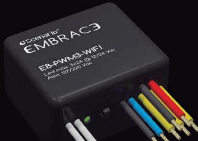
Módulo WI-FI para acionamento de 3 canais de fitas led com tensão constante de 12 ou 24 volts. Pode ser utilizado no modo RGB ou canais independentes. Tem alimentação em 127/220V AC. Possui duas entradas auxiliares com acionamento AC que pode ter a sua função programada no sistema Embrace ou acionar localmente os canais em caso de falha na comunicação com o controlador Embrace. Apresenta modos autônomos de efeitos de troca de cores com parâmetros ajustáveis.
